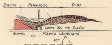
Detalle del anticlinal del km. 5. Carretera de Bailén (Corte por A-B)
